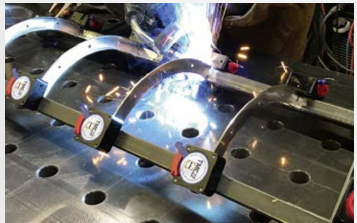
Anstatt umständlichem Klammern: der TMC 70 zum einfachen Fixieren von Metallteilen für Schweiß-Arbeiten
