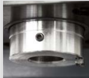
Stabile Kolbenstange (Ø 55 mm) mit Werkzeugverdrehsicherung
