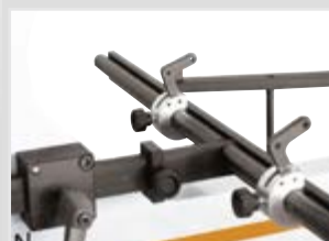
Längen- und Tiefenanschlag mit klappbaren Nachsetzanschlüssen
