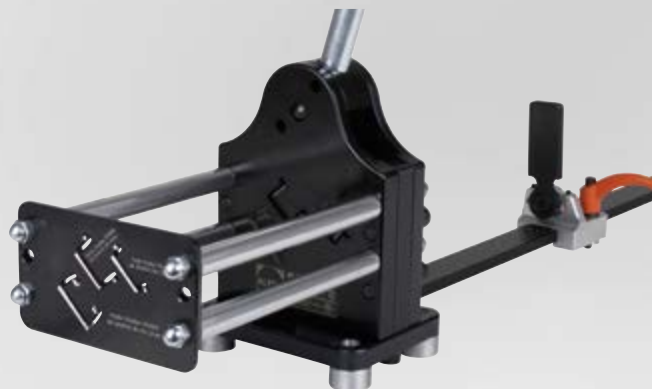
Führungsvorrichtung zum 90°- winkelgenauen Schneiden
