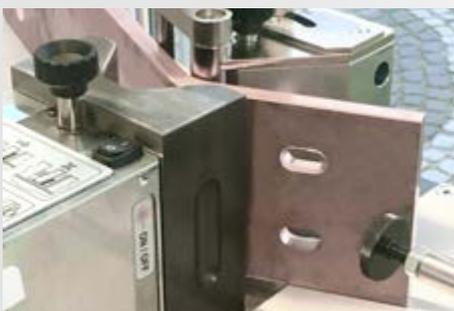
Sans rails de contact, rien ne fonctionne dans l'armoire électrique. Littéralement. C'est pourquoi nos appareils de coupe, de pliage et de perforation veillent à ce que les rails de cuivre prennent la forme exacte indiquée par le plan de construction rapide. Différentes applications sont possibles avec un seul cylindre de travail en insérant simplement les poinçons nécessaires.
