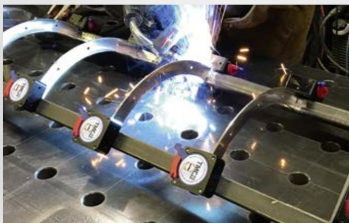
Au lieu de l'agrafage compliqué : le TMC 70 pour la fixation simple de pièces métalliques pour les travaux de soudure
