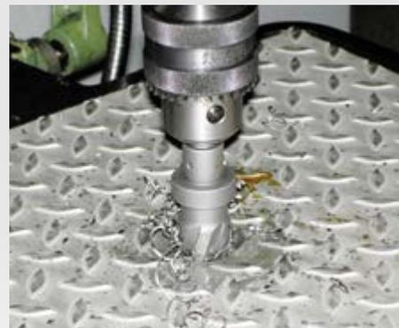
Perçer dans de la tôle ondulée
