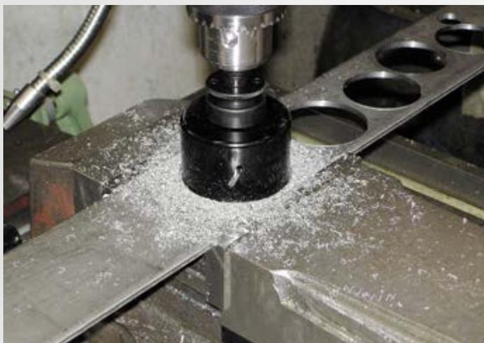
*L'acier/l'acier inoxydable aussi peuvent être facilement usinés jusqu'à environ 3 mm (pour les utilisations fréquentes, nous recommandons nos scies trépan en carbure).*
