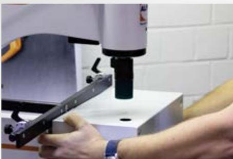
Notre Alfra-Press-Trio en blanc pour des perçages sans effort dans les boîtiers et les portes d'armoires électriques. Nos poinçons fixes permettent de réaliser des ouvertures rondes, carrées et rectangulaires, selon le modèle, sans pré-perçage et en une seule étape.
