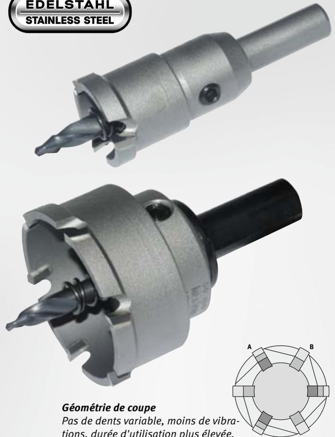
Cette scie trépan en carbure est un modèle multi-applications d'utilisation universelle jusqu'à une épaisseur de matériau de 10 mm (3/8'') maxi. (sans ressort d'éjection). Par sa construction solide et une géométrie de coupe encore plus développée (modèle 202 03 232 9), on obtient un comportement de coupe considérablement amélioré en relation avec une performance de coupe et une durée d'utilisation élevées.
