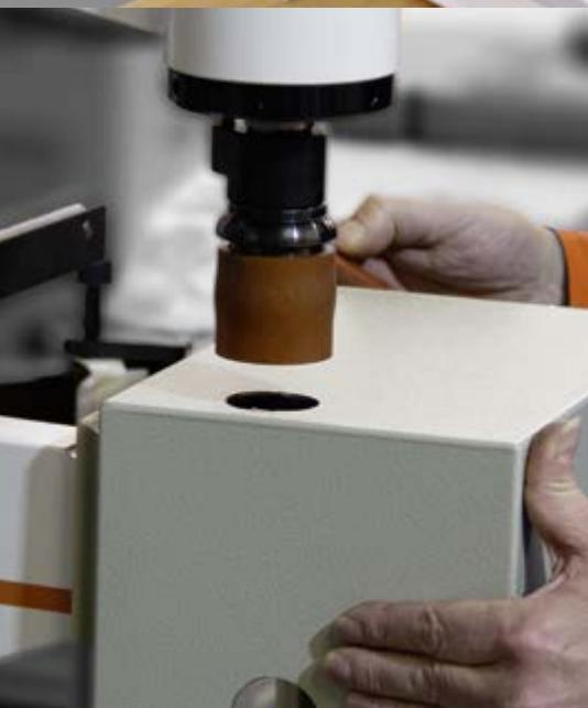
« Pour fabriquer des produits proches des besoins des constructeurs d'armoires électriques, il faut s'immerger dans leur univers de travail. C'est pourquoi les appareils de la série Press disposent de différents détails adaptés aux exigences de l'artisanat. Un exemple : grâce aux différents supports de matrice, les utilisateurs peuvent poinçonner même dans les zones de bordure extrêmes. Un pointeur laser indique le centre de l'outil »
