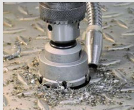
Percer dans de la tôle ondulée
